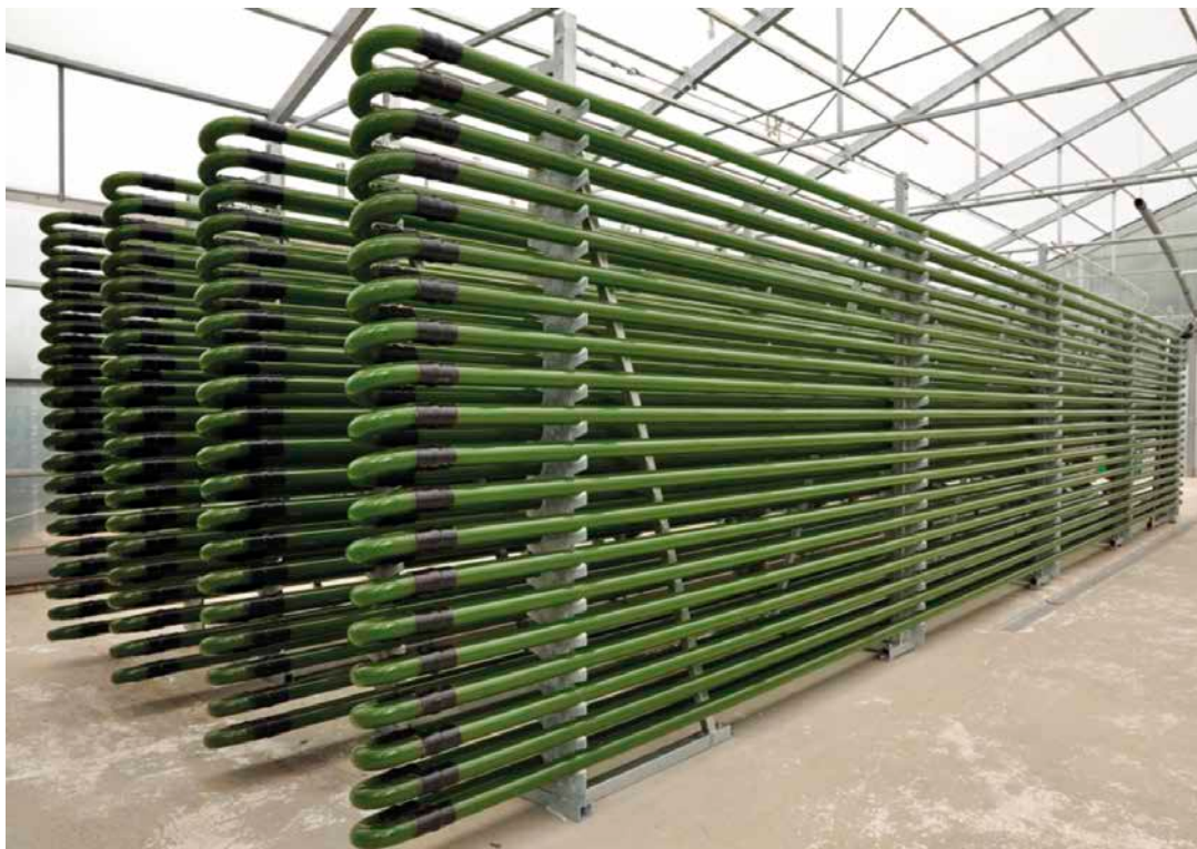
Obrázek 1: Fotoreaktor s vodorovným potrubím
